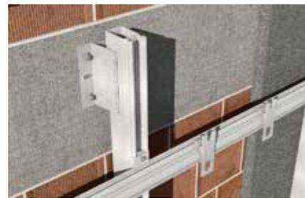
Dettaglio: collegamento al montante
