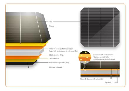
Il nostro potente modulo Panasonic HIT° N335 è caratterizzato da un'alta efficienza (20,0%), dal miglior coefficiente di temperatura del settore (-0,258%/°C) e da un elegante design.
