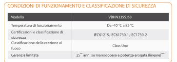
NOTA: Condizioni di prova standard: Massa d'aria 1,5; irraggiamento =  $1000 \, \text{W/m}^2$ ; temp. celle 25 °C
