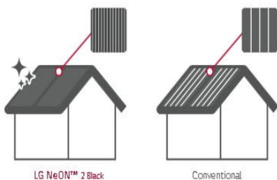
I nuovi moduli sono stati progettati affinché i moduli visti da lontano sembrano completamente neri.
