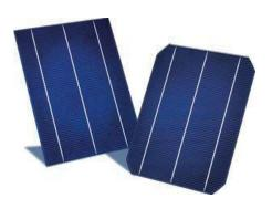
Il wafer viene poi ripulito eliminando le imperfezioni derivanti dal processo di segatura. Grazie a una procedura di diffusione del fosforo il wafer diviene una cella solare con proprietà conduttive. Dopo l'eliminazione del fosforo che si è depositato nella fase precedente, viene applicato uno strato antiriflesso necessario per ridurre le perdite elettriche delle superfici. Verranno poi applicati anche i contatti sulle parti anteriore e posteriore in modo da crearvi un campo magnetico.
