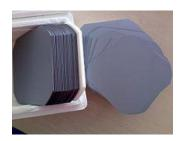
Il terzo passaggio produttivo consiste nella trasformazione dei wafer in celle solari, componenti di base dei futuri moduli solari. Le celle dispongono già di tutte le caratteristiche tecniche necessarie per produrre l'energia sfruttando la luce solare. L'irradiazione luminosa consente la formazione, all'interno delle celle, dei portatori di carica positivi e negativi, attraverso i quali passerà l'energia elettrica (corrente continua).
