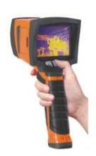
Con l'obbiettivo di programmare manutenzioni vantaggiose ed efficienti, il nostro team utilizza un nuovo strumento: la termocamera THT.
